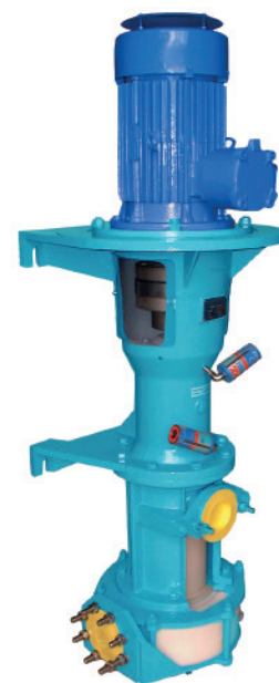
► BVS Sans Palier de pied (CANTILEVER) Sans Garniture mécanique Version extérieure avec collecteur de fuite gravitaire Max : 1200 m³/h • H 100 m • P 160 KW Application : bains de décapage avec grandes capacités
