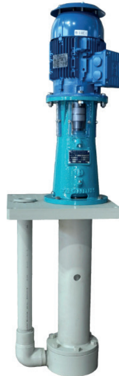
► BAS Sans Palier de pied (CANTILEVER) Version courte Longueur sous plaque : 700 mm max Max : 70 m³/h • H 45 m • P 7.5 KW
