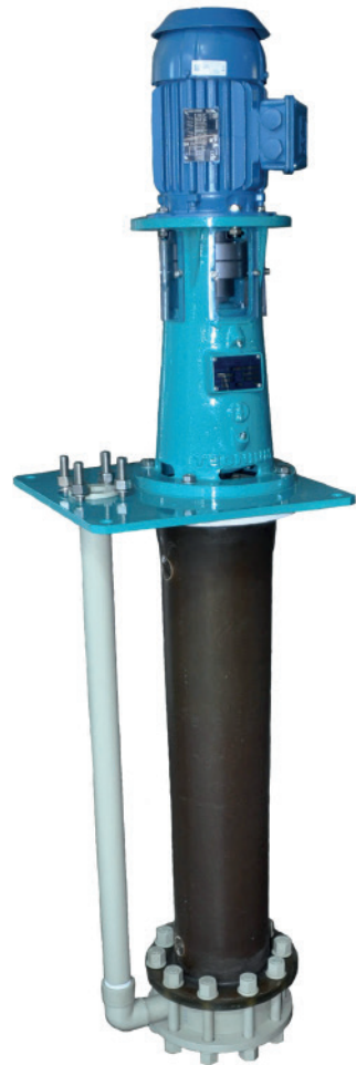
► BTS Sans Palier de pied (CANTILEVER) Version longue Longueur sous plaque : 1200 mm max Max : 400 m³/h • H 90 m • P 45 KW
