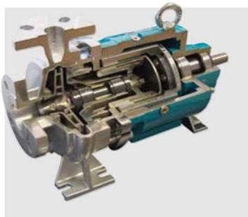
Lorsque les pompes fonctionnent dans de bonnes conditions, les paliers lisses ne s'usent pas. Cependant, si les pompes tournent à sec ou s'il y a un défaut de lubrification, la chaleur produite par la friction des paliers lisses est si élevée que la plupart des paliers se détériorent en à peine quelques secondes.
