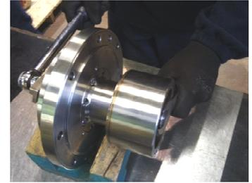
**Fig.62** Tenir l'arbre avec une clé fixe serrer l'écrou de serrage.
