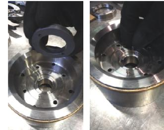
**Fig.42** Retirer la butée rotative (510) et les pion (560.x).
