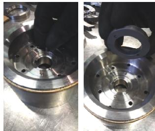
**Fig.52** Insérer les piones de traction (560.x) et la butée rotative (510).
