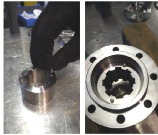
**Fig.49** Insérez les pion (560.x) dans le bague entretoise (504), puis placez-les dans le porte paliers (352).
