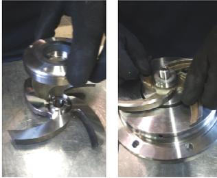
**Fig.60** Insérer tout l'ensemble butée rotative sur la turbine (240).
