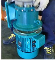
**Fig. 26** Déposer la pompe du moteur électrique. Utiliser des engins de levage appropriés et prendre garde à l'attraction provoquée par le coupleur magnétique interne sur l'externe.
