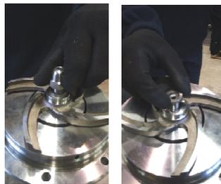
**Fig. 32** Retirez le contre-écrou (922) et la rondelle de sécurité (931.x).
