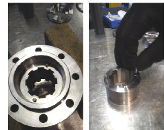
**Fig.45** Retirer les pion des palier statiques (560.x) et le bague entretoise (504).
