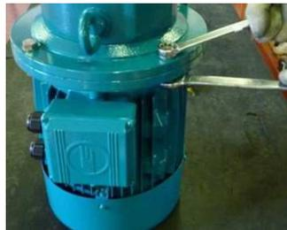
**Fig.67** Visser les vis et les écrous.
