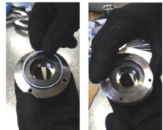
**Fig.59** Insérer le joint (411.x) sur la butée rotative et le fermer avec la couvercle (471.x) en utilisant les vis / rondelles appropriées.
