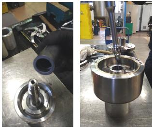
**Fig.40** Retirer la languette (529) du palier rotatif (940) et l'arbre (211); Dévisser le bouchon de vidange (912.x) à l'arrière du coupleur magnétique interne (855), en veillant à ce que le couvercle garniture (471.x) ne tombe pas.
