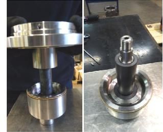
**Fig.39** Retirer le porte paliers (351+352) du palier rotatif (529).
