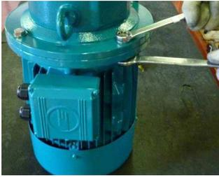
**Fig. 25** Pour un démontage aisé, placer la pompe à la verticale et dévisser les vis bloquant la lanterne-moteur.
