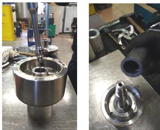
**Fig.54** Tourner le coupleur magnétique interne et serrer les vis (912.x); insérer l'arbre (211) avec le joint (411.x) et le palier rotatif (545) plus la languette (940).
