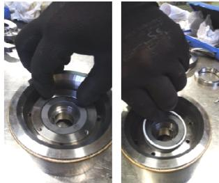
**Fig.41** Tournez le coupleur magnétique interne et enlevez le couvercle (471.x) et le joint (411.x).
