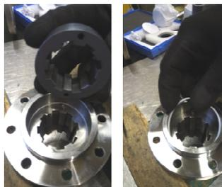
**Fig.44** Retirez le palier statique (545) et le joint torique (412).
