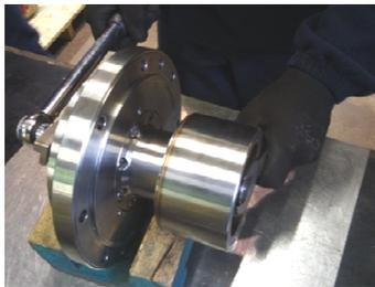
**Fig. 31** Tenez l'arrière de l'arbre rotatif (211) avec une clé et dévissez le contre-écrou (922).
