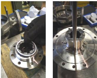
**Fig.51** Insérez le joint (411) sur la douille avant et insérez-le dans le porte paliers (351), en le fixant avec les joint (411) + rondelle de sécurité (931.x).
