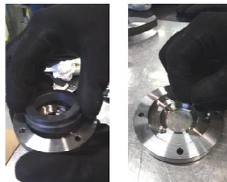
**Fig. 35** Retirer la butée rotative (510) et les pion (560.x).
