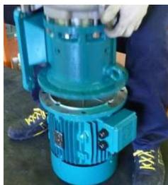
**Fig.66** Placez le moteur verticalement et placez la pompe par-dessus.
