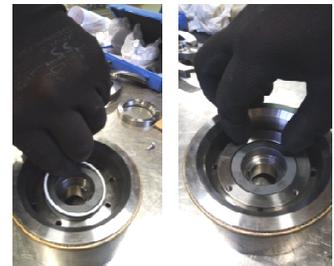
**Fig.53** Placer le joint (411.x) sur la butée rotative et le fermer avec la couvercle (471.x).
