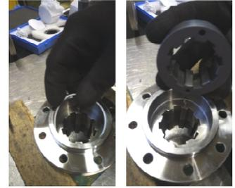
**Fig.50** Insérez le joint torique (412) et la paliere statique avant (545).
