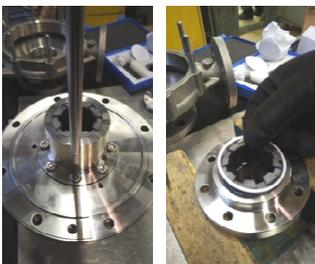
**Fig.43** Dévisser les vis de fixation du moyeu (914.x) et retirer les rondelles de sécurité (931.x) et le joint (411.x).
