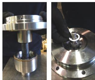
**Fig.55** Insérer la porte palier (351) sur le palier rotatif et positionner le joint (411.x).
