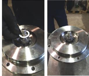
**Fig.38** Retirer la joint de compensation (411.x) et le butée rotative (510).
