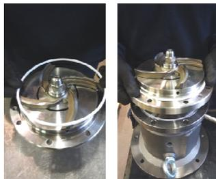
**Fig.63** Positionner le joint (411.x) et poser l'ensemble hydraulique sur la lanterne(344)
