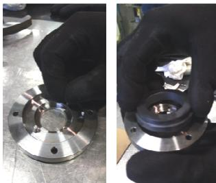
**Fig.58** Insérez les pion (560.x) dans la couvercle (471.x), puis la butée rotative.
