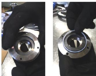
**Fig. 34** Dévisser les vis de montage de la bride et retirer le joint (411.x).
