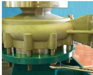
**Fig.64** Monter le corps de pompe (102) sur la lanterne (344), serrer les écrous (920.x) et les rondelles (931.x).
