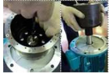
**Fig. 27** Dévisser la vis (918) avec la rondelle (555) de l'arbre du moteur électrique. Déposer le coupleur magnétique externe (856) de l'arbre du moteur électrique.
