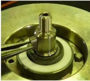
**Fig.37** Retirez la languette avant (940) de l'arbre (211).
