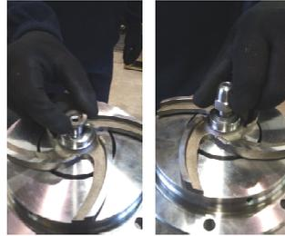
**Fig.61** Insérez la rondelle de sécurité (931.x) et fermez-la avec le écrou (922).
