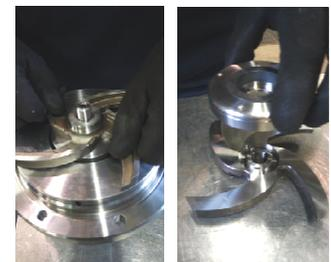
**Fig. 33** Retirer la turbine (240) et l'ensemble de le support.
