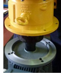
**Fig. 28** Déposer la pompe du moteur avec le coupleur magnétique externe (856) à l'aide d'un engin de levage approprié.
