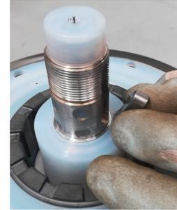
**Fig. 35** Désengager la rondelle (231.x) et dévisser la bague (504.x). Utiliser une clé 46.
