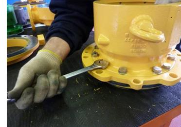
**Fig. 31** UNIQUEMENT pour la SÉRIE 200 : Retirer les vis pour pouvoir extraire la lanterne (344) du porte paliers (350).
