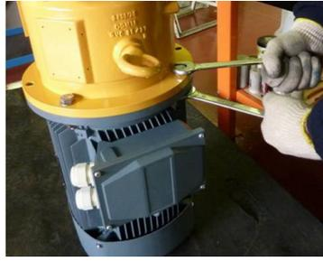
**Fig. 27** Dévisser les vis pour séparer la lanterne (344) du moteur.
