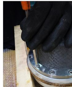
**Fig. 33** Desserrer les vis et les rondelles de la bride de bol (159). Extraire : bride + revêtement + bol d'isolation.
