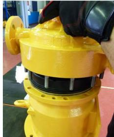
**Fig. 30** Démontez le corps de pompe (102) de la lanterne (344), en dévissant les écrous appropriés.
