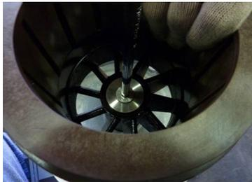
**Fig. 29** Desserrer la vis (918.x) pour démonter le coupleur magnétique externe (856) du moteur.
