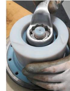
**Fig. 34** Dévisser la bague (923) de la turbine (230). Utiliser clé 50.
