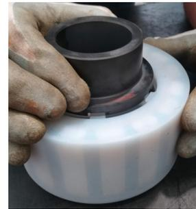
**Fig. 38** Extraire le support des douilles (350) de la roue (240).
