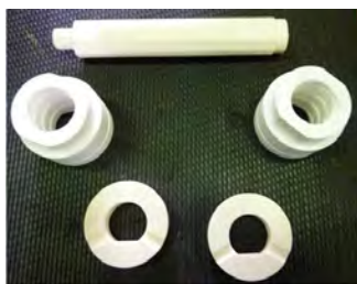
Fig. 37 Voilà le groupe des paliers formé de l'arbre statique (211), des butées rotatives (510) et des paliers rotatifs (529).
