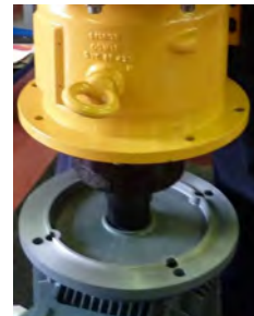
Fig. 29 Déposer la pompe du moteur avec le coupleur magnétique externe (856) à l'aide d'un engin de levage approprié.
