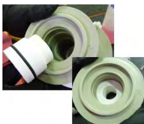
Fig. 53 Poser les paliers rotatifs (529) sur l'ensemble turbine (240).
