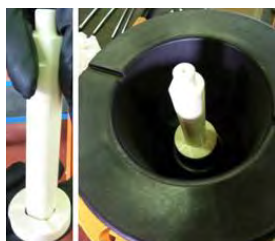
Fig. 51 Accoupler l'arbre statique (211) et le butée rotative (510). Cette dernière doit avoir les 3 rainures tournées vers la partie interne de l'arbre. Introduire l'arbre avec la butée dans le bol (157) de façon que les 3 rainures sur la butée soient visibles.
