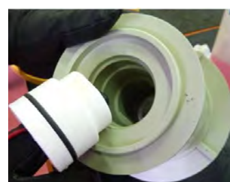
Fig. 35 Enlever les paliers rotatifs (529) avec leur joint torique de blocage (412.2) de l'ensemble turbine (240).
