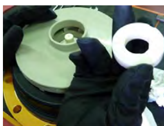
Fig. 33 Extraire la butée rotative (510) de l'arbre (211).
