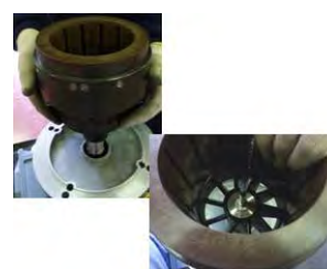
Fig. 58 Poser le coupleur magnétique externe (856) sur l'arbre primaire. Visser la vis (918) avec la rondelle correspondante (555) en utilisant le frein filet de type Loctite 243 pour garantir le serrage.
