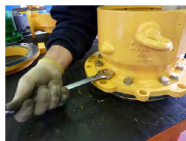
Fig. 41 UNIQUEMENT pour la SÉRIE 200 : Dévisser les vis pour pouvoir déposer la lanterne (344) de la bride d'adaptation (159) au corps de pompe.
