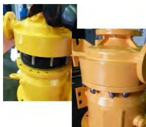
Fig. 57 Monter le corps de pompe (102) avec les goujons (902) vissés, sur la lanterne (344) en vissant les écrous avec leurs rondelles.
