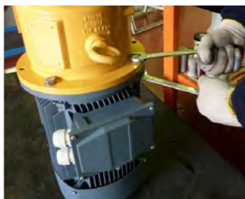
Fig. 28 Dévisser les vis pour séparer la lanterne (344) du moteur.
