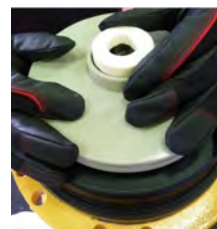
Fig. 55 Poser la butée rotative (510) sur l'arbre (211) en veillant à placer les 3 rainures vers le palier rotatif (529).
