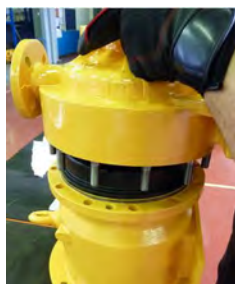
Fig. 31 Démonter le corps de pompe (102) de la lanterne (344) en dévissant les écrous prévus à cet effet.
