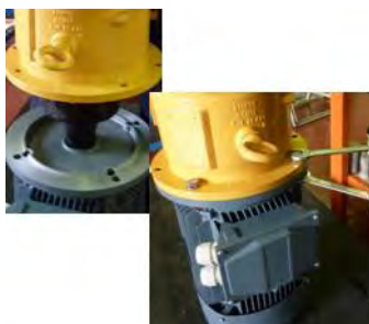
Fig. 59 Installer la pompe sur le moteur à l'aide d'un engin de levage approprié. Visser le moteur sur la lanterne (344) verticale. Fig. 60 Pour un montage pratique, maintenir la pompe à la verticale. Serrer les vis pour fixer le châssis (891) à la pompe. avec les vis prévues à cet effet.
