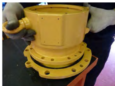
Fig. 42 UNIQUEMENT pour la SÉRIE 200 : Déposer la lanterne (344) de la bride d'adaptation (159) au corps de pompe.
