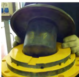
Fig. 39 Déposer le bol d'isolation (157) de la lanterne (344).
