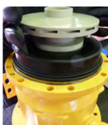
Fig. 54 Emboîter le tout sur l'arbre statique (211).
