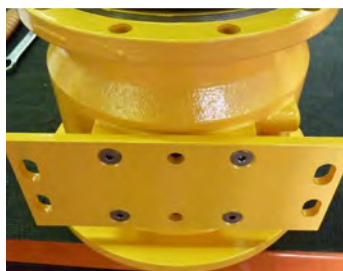
Fig. 45 Fixer l'entretoise (892.1) à la lanterne (344) à l'aide des vis.
