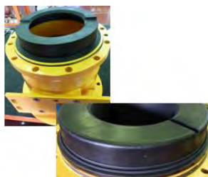
Fig. 50 Poser le bol d'isolation (157) dans la lanterne (344) et emboîter le joint torique (412.1) sur le bol (157).
