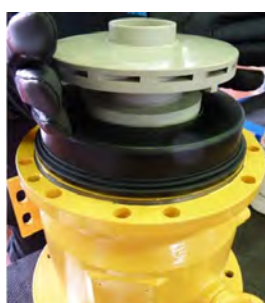
Fig. 34 Déposer l'ensemble turbine (240) de l'arbre (211).
