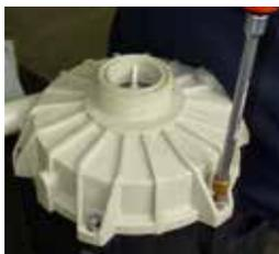
**Fig. 25** Démonter le corps de pompe (102) de la lanterne (344) en dévissant les vis prévues à cet effet.
