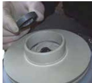
**Fig. 49** Poser la butée rotative (510) sur l'arbre (211).
