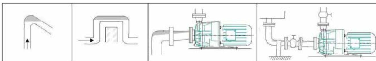
*Fig. 16 Installation déconseillée de la tuyauterie d'aspiration.*
