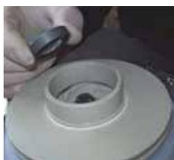
**Fig. 26** Ôter la butée rotative (510) de l'arbre (211).
