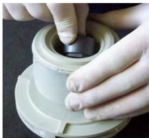
**Fig. 47** Poser les paliers rotatifs (529) sur l'ensemble turbine (240).
