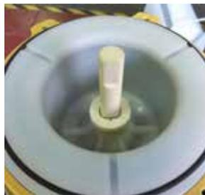
**Fig. 45** Introduire l'arbre (211) avec la butée (510) dans le bol (157) de façon que les 3 rainures sur la butée soient visibles.
