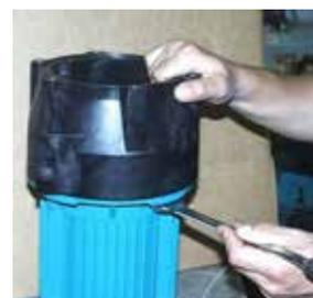
**Fig. 38** Introduire la bride moteur (347) sur le centrage du moteur. Pour des moteurs de grandeur 100/112 forme B3-B14, visser l'entretoise (348) sur la lanterne et la bride (347) sur le moteur (voir détail Paragraphe 6.2).
