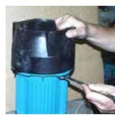
**Fig. 33** Déposer le moteur avec le coupleur magnétique externe (856) et la bride du moteur (347) de la lanterne (344) en dévissant les vis prévues à cet effet.
