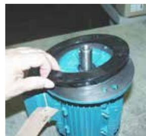
**Fig. 36** Déposer la bride moteur (347).
