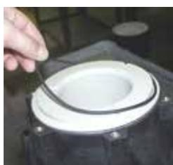
**Fig. 31** Déposer le joint torique (412.1) du bol (157).
