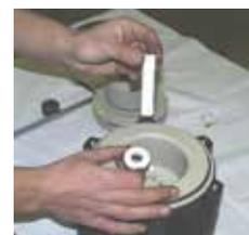
**Fig. 30** Ôter l'arbre statique (211) et la butée rotative (510) du bol d'isolation (157).
