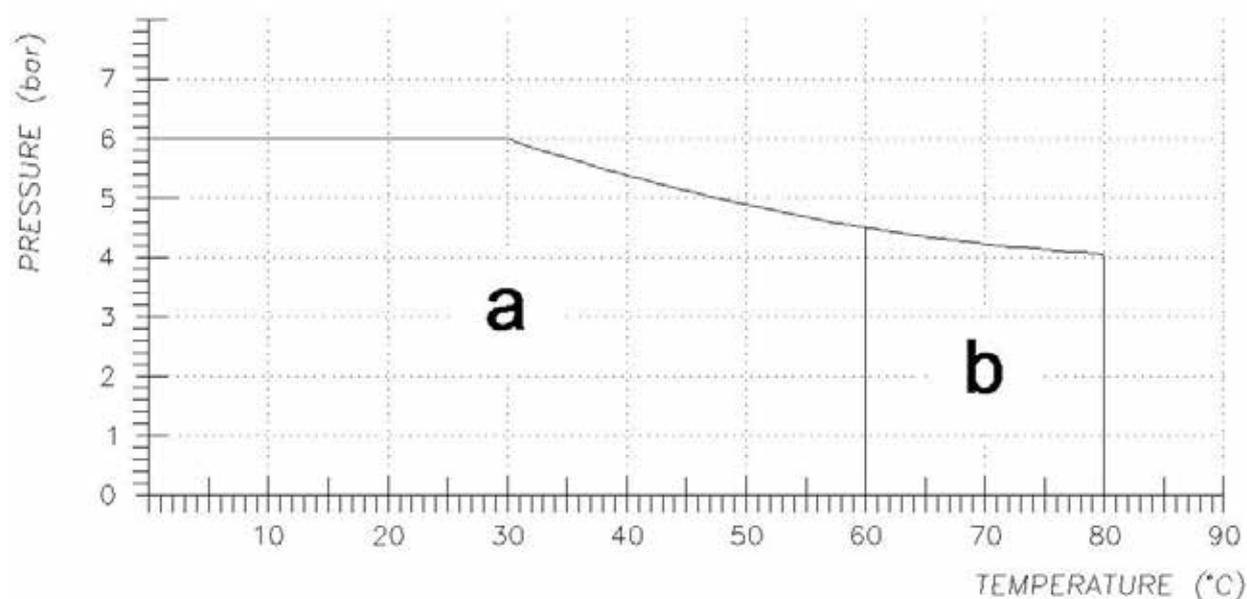
**Fig. 21** STN 30/40 dans PP-GF (a) et dans ETFE-CF (a+b)
