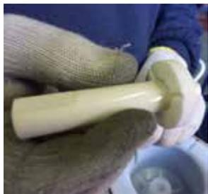
**Fig. 44** Accoupler l'arbre statique (211) et la butée rotative (510). Cette dernière doit avoir les 3 rainures tournées vers la partie la plus saillante de l'arbre.
