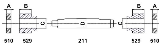
Fig. 37 Butées rotatives, palier rotatif et arbre susceptibles d'usure.
