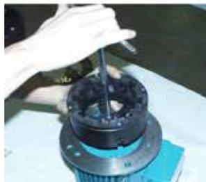
**Fig. 35** Dévisser la vis (918) pour déposer le coupleur magnétique externe (856) du moteur.
