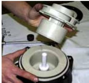
**Fig. 48** Emboîter le joint torique sur l'arbre statique (211).
