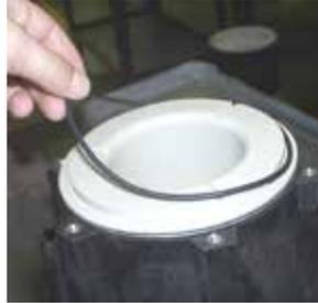
**Fig. 42** Emboîter le joint torique (412.1) sur le bol (157).
