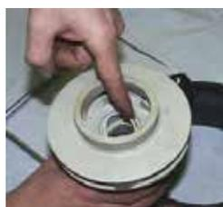
**Fig. 29** Enlever le joint torique bloquant les paliers (412.2) de l'ensemble turbine (240).
