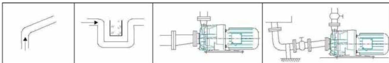
*Fig. 15 Installation recommandée de la tuyauterie d'aspiration.*
