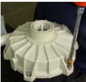
**Fig. 50** Monter le corps de pompe (102) sur la lanterne (344) en vissant les vis prévues à cet effet (914.1) avec les rondelles. Interposer entre les vis et les rondelles :- les rondelles coniques pour corps en ETFE ou ETFE-CF- les rondelles grower pour corps en PP-GF
