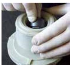
**Fig. 28** Enlever les paliers rotatifs (529) de l'ensemble turbine (240).
