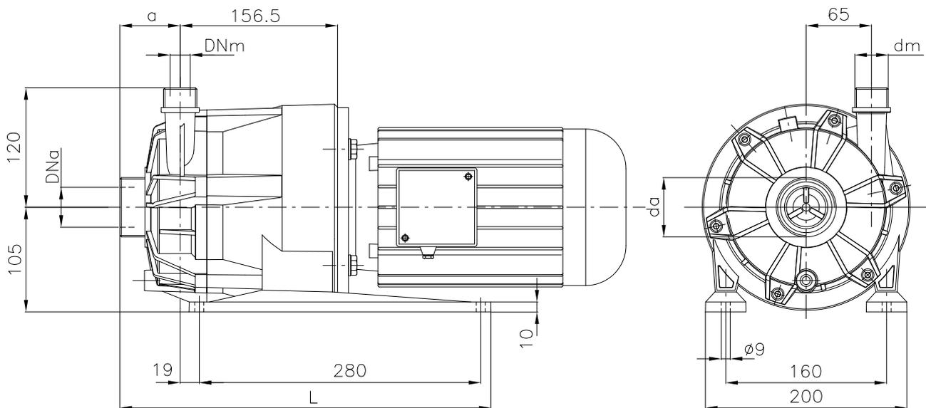
Fig. 51 Schéma d'encombrement de la pompe STN 30/40 avec cotes en mm moteur taille 80/90.
