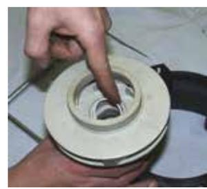
**Fig. 46** Placer le joint torique de blocage des paliers (412.2) sur l'ensemble turbine (240).
