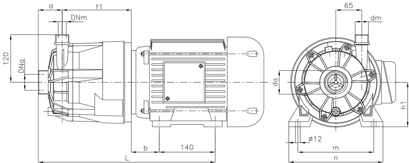
**Fig. 53** Schéma d'encombrement de la pompe STN 30/40 avec cotes en mm moteur taille 100/112
