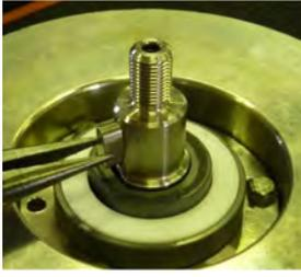
**Fig. 37** Extraire la clavette avant (940) de l'arbre (211).
