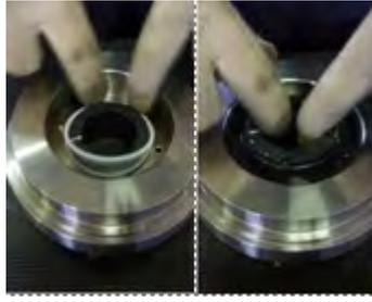
**Fig. 47** Pour les pompes du « 1er support » : enlever le joint (411) et le palier statique (545) avant. Retourner le support (350) et répéter les opérations depuis la fig. 45 pour extraire le palier statique (545) arrière.
