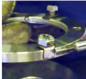
**Fig. 52** Pour les pompes du « 1er support » : dans les trous de la bride de blocage du palier (935), insérer les vis à tête six pans (901) et les rondelles de sécurité respectives (931) et les plier sur le bord extérieur de la bride (935).
