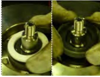
**Fig. 38** Retirer la bague de compensation (504) et la butée avant (510).
