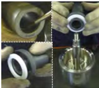
**Fig. 54** Attention ! Sur le palier rotatif (529), insérer les composants du côté correspondant au fraisage interne comme indiqué. Insérer : la butée arrière (510), la bague de compensation du jeu axial (504). Dans la version « haute température », insérer la bague Grafoil renforcée (504) dans la butée (510) puis la cale métallique (504). Insérer le tout sur l'arbre secondaire (211).
