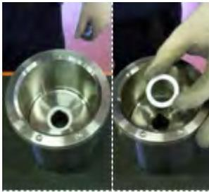
**Fig. 49** Retirer le joint du palier rotatif (411) du coupleur magnétique interne (855).
