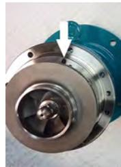
**Fig. 55** Placer le trou de lubrification présent sur le support des paliers (350) dans la position indiquée.
