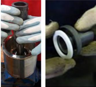
**Fig. 40** Retirer de l'arbre de turbine (211) : le palier rotatif (529), la butée arrière (510) puis la bague de compensation (504).
