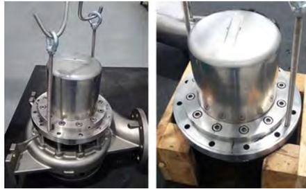
**Fig. 32** Retirer le support assemblé du boîtier de volute (102) et le poser sur une entretoise stable
