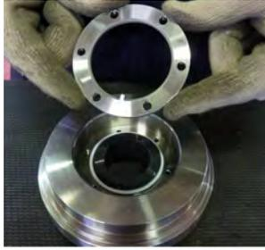
**Fig. 46** Pour les pompes du « 1er support » : extraire la bride de blocage du palier (935) du support des paliers (350).
