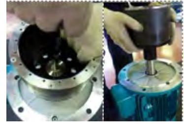
**Fig. 30** Dévisser la vis (918) avec la rondelle (555) de l'arbre du moteur électrique. Retirer le noyau magnétique externe (856) de l'arbre du moteur électrique.
