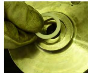
**Fig. 36** Retourner la turbine (230) et extraire le joint du palier rotatif (411).
