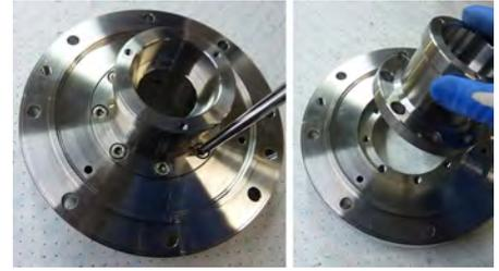
**Fig. 48** Pour les pompes du « 1er support » : en cas de support des paliers distal (351 + 352), dévisser les vis (914) et les rondelles (931) pour séparer la « bride » (351) du « logement » (352).
