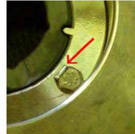
**Fig. 53** Pour les pompes du « 1er support » : positionner la bride de serrage des paliers (935) en faisant correspondre la dent anti-rotation avec la fente du palier statique (545). Serrer les vis (901), plier et bloquer les rondelles. Retourner le support (350) et répéter les mêmes opérations pour monter l'autre palier statique (545).
