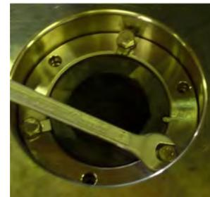
**Fig. 45** Pour les pompes du « 1er support » : du support des paliers (350), dégager les rondelles de blocage indiquées par la flèche (931) des vis (901) et dévisser de la bride de blocage du palier (935).
