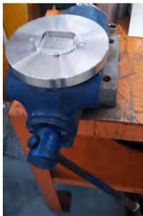
**Fig. 34** Serrer dans un étau d'établi l'équipement approprié (si disponible) et, sur ce dernier, placer le support assemblé.
