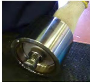
**Fig. 41** Retirer l'arbre de turbine (211) du coupleur magnétique interne (855).
