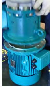
**Fig. 29** Séparer la pompe du moteur électrique. Utiliser des engins de levage appropriés et prendre garde à l'attraction provoquée par le coupleur magnétique interne sur l'externe.
