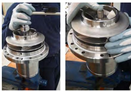
**Fig. 35** Dévisser et enlever : l'écrou de turbine (922), la rondelle (931) et la turbine (230).
