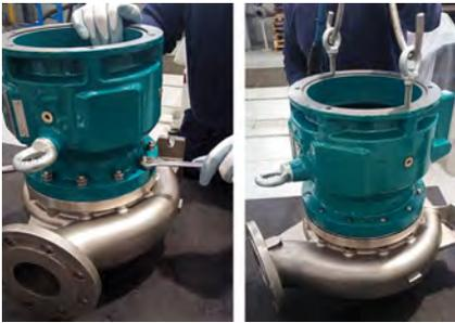
**Fig. 31** Dévisser les écrous (920) et séparer la lanterne (344) du boîtier de volute (102) en utilisant les systèmes de levage appropriés.
