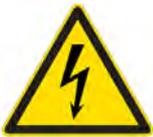
**DANGER TENSION ÉLECTRIQUE** : indique la présence d'un danger imputable à des appareils électroniques.
