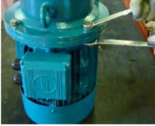
**Fig. 28** Pour les pompes avec moteur de forme B5 et B14, séparer le châssis, positionner la pompe verticalement et dévisser les vis + écrous de blocage du moteur.
