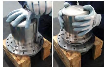
**Fig. 33** Si présents, dévisser les vis (914) et retirer le bol d'isolation (157).
