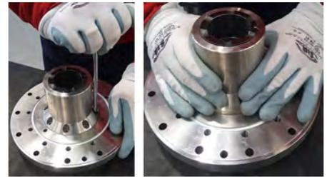
**Fig. 42** Pour les pompes du « 11ème support » : dévisser les vis (914) et les rondelles (931) pour séparer la « bride » (351) du « logement » (352) du support des paliers.
