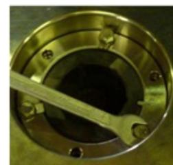
**Fig. 67** Placer la bride de blocage de paliers (935) en veillant à mettre à la même hauteur la dent anti-rotation et l'encoche du palier statique (545). Serrer les vis (901.1).
