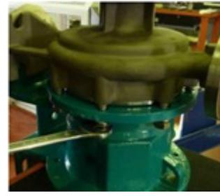
**Fig. 99** Reposer le corps de pompe (102) sur la lanterne (344) en vissant les écrous prévus à cet effet (920.1).
