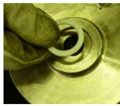
**Fig. 95** Introduire le joint du palier rotatif (411.1) dans le logement de la turbine (230).
