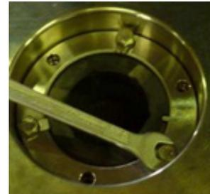
**Fig. 90** Placer la bride de blocage de paliers (935) en veillant à mettre à la même hauteur la dent anti-rotation et l'encoche du palier statique (545). Ser- rer les vis (901.1).
