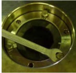
**Fig. 41** Dévisser les vis à tête hexagonale (901.1) de la bride de blocage de palier (935).
