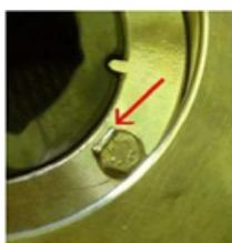
**Fig. 68** Soulever et replier les rondelles de sécurité (934) sur le plan de la tête des vis (901.1) en veillant à ne pas abîmer le palier statique (545).
