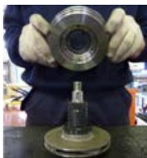
**Fig. 34** Extraire le support (350) du palier rotatif (529) emboîté sur l'arbre de turbine (240).
