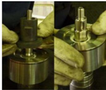
**Fig. 57** Déposer le palier rotatif (529) et la butée rotative (510), puis le coupleur magnétique interne (855) de l'arbre de turbine (211).
