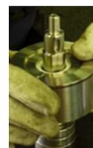
**Fig. 84** Introduire le coupleur magnétique interne (855) de façon qu'il soit en butée sur l'arbre (211).
