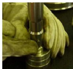
**Fig. 83** Placer l'arbre (211) à la verticale sur un support cylindrique et introduire la languette (940.1) dans le logement prévu à cet effet.
