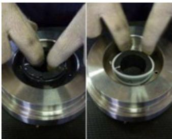
**Fig. 88** Attention ! Placer l'encoche anti-rotation du palier statique (545) du côté supérieur. Poser le palier statique (545) et son joint (411.2) dans le support (350).
