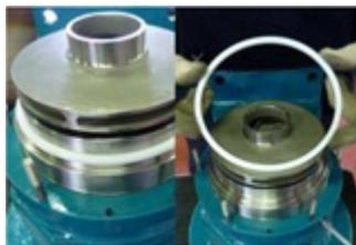
**Fig. 29** Ôter le joint (411.3) du support (350).
