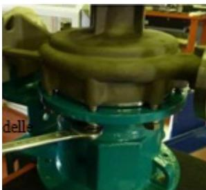
**Fig. 48** Pour un démontage pratique, placer la pompe à la verticale. Démontez le corps de pompe (102) de la lanterne (344) en dévissant les écrous prévus à cet effet (920).
