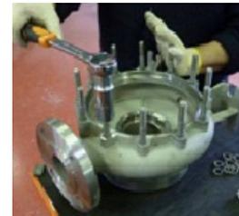
**Fig. 81** Visser les goujons (902.1) sur le corps de pompe (102) en laissant dépasser la plus longue extrémité filetée.
