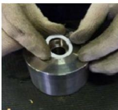
**Fig. 82** Introduire le joint de palier rotatif (411.1) dans le logement du coupleur magnétique interne (855).
