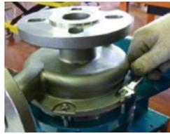
**Fig. 75** Reposer le corps de pompe (102) sur la lanterne (344) en vissant les écrous prévus à cet effet (920.1)
