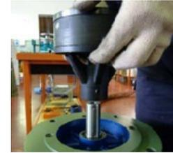
**Fig. 76** Emboîter le coupleur magnétique externe (856) sur l'arbre du moteur électrique.
