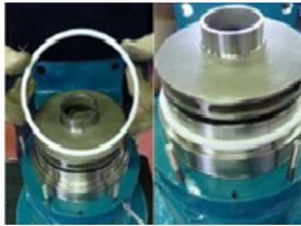
**Fig. 74** Reposer le joint (411.3) sur le porte palier (350).
