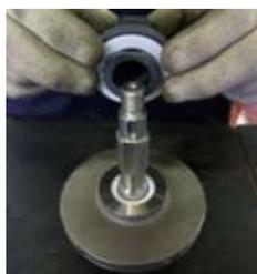
**Fig. 35** Ôter le palier rotatif (529) et la butée avant (510) de l'arbre de turbine (240).
