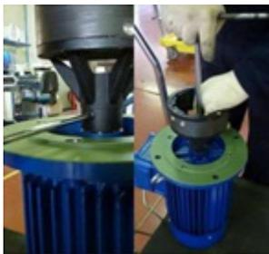
**Fig. 46** Dévisser le grain (904) avec la vis (901.2) de l'arbre du moteur électrique.
