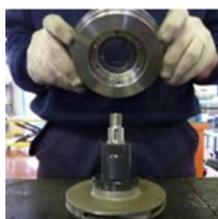
**Fig. 69** Reposer le support (350) sur le palier rotatif (529) emboîté sur l'arbre de turbine (211).
