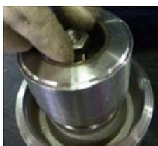
**Fig. 72** Introduire la rondelle élastique et visser l'écrou fileté gauche (921) sur l'arbre de la turbine (211).
