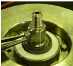
**Fig. 54** Extraire la languette avant (940.1) de l'arbre (211).
