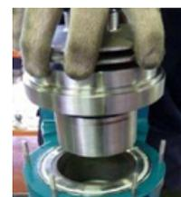
**Fig. 73** Introduire le groupe du porte paliers (350), la turbine (230) et le coupleur magnétique interne (855) dans le bol d'isolation (157).
