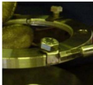
**Fig. 89** Dans la bride de blocage de palier (935), introduire les vis à tête hexagonale (901.1) et leurs rondelles de sécurité (934) dans les 3 trous à 120°. Plier les rondelles de sécurité (934) sur le bord extérieur de la bride de blocage de palier (935).
