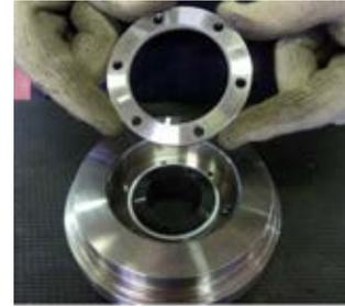
**Fig. 42** Déposer la bride de blocage de palier (935) du support (350).
