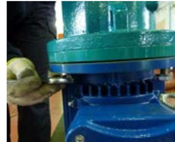
**Fig. 45** Dévisser et ôter les écrous (920.2) et séparer la lanterne (344) du moteur électrique.
