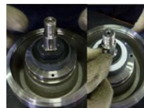
**Fig. 70** Introduire la butée arrière (510) avec son anneau de compensation (504.1) sur le palier rotatif (529). Passer la languette (940.2) dans la fente de l'arbre de turbine (211).
