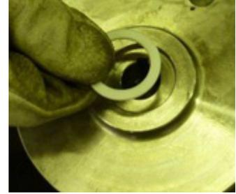
**Fig. 53** Retourner la turbine (230) et extraire le joint du palier rotatif (411.1).
