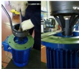
**Fig. 77** Bloquer le coupleur magnétique externe (856) avec la vis (901.2). Garantir le serrage avec du frein filet de type Loctite 243. Visser le grain (904).
