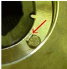
**Fig. 91** Soulever et replier les rondelles de sécurité (934) sur le plan de la tête des vis (901.1) en veillant à ne pas abimer le palier statique (545).
