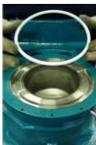
**Fig. 38** Ôter le joint du bol (411.4) du bol d'isolation (157).
