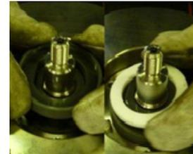
**Fig. 93** Introduire la butée avant (510) avec son anneau de compensation (504.1) dans le palier rotatif (529).
