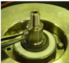
**Fig. 94** Passer la languette (940.1) dans la fente de l'arbre de turbine (211).
