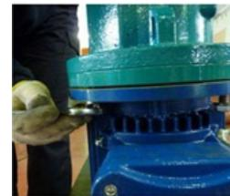
**Fig. 78** Monter la lanterne (344) sur le moteur avec les écrous spéciaux (920.2).
