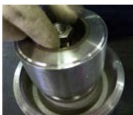
**Fig. 31** Après avoir renversé le groupe porte-paliers, dévisser et ôter l'écrou fileté gauche (921) de l'arbre de la turbine (240).
