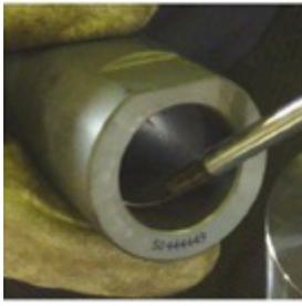
**Fig. 85** Attention ! Monter le palier rotatif (529) avec l'alésage le plus grand tourné du côté coupleur magnétique interne (855).
