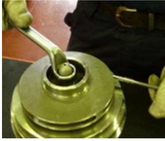
**Fig. 51** Garder la turbine bloquée en introduisant une clé fixe dans le compartiment des pales et dévisser l'écrou de turbine (922). Ôter l'écrou de turbine (922) de l'arbre (211).
