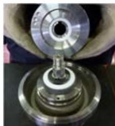
**Fig. 32** Déposer le coupleur magnétique interne (855) de l'arbre de la turbine (240).
