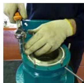
**Fig. 59** Placer la lanterne (344) à la verticale, introduire le bol (157) en vérifiant dans le logement du bol prévu à cet effet si le trou sur la bride du bol est en position par rapport au trou de la poche de sonde thermique sur la lanterne. Utiliser une clé comme référence de position en la laissant en place jusqu'en fin de montage.
