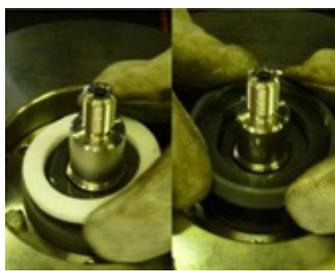
**Fig. 55** Ôter l'anneau de compensation (504.1) et la butée avant (510).
