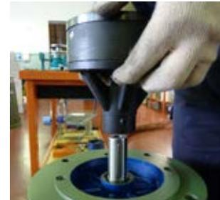
**Fig. 47** Déposer le coupleur magnétique externe (856) de l'arbre du moteur électrique.
