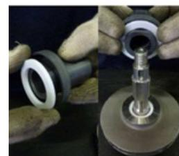
**Fig. 64** Sur le palier rotatif (529) introduire : la butée rotative avant (510) et l'anneau de compensation du jeu axial (504.1). Reposer le tout sur l'arbre de la turbine (211).
