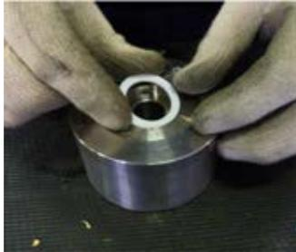
**Fig. 44** Enlever le joint de palier rotatif (411.1) du coupleur magnétique interne (855).
