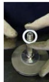
**Fig. 36** Ôter le joint du palier rotatif (411.1) de la turbine (230).
