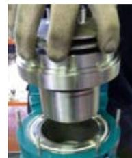
**Fig. 30** Séparer le groupe du porte-paliers (350), turbine (230) et coupleur magnétique interne (855) du bol d'isolation (157).
