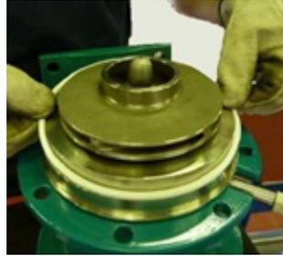
**Fig. 98** Reposer le joint (411.4) sur le porte palier (350).
