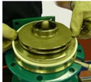
**Fig. 49** Ôter le joint (411.4) du support (350).
