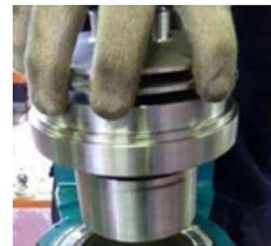
**Fig. 50** Séparer le groupe du porte paliers (350), turbine (230) et coupleur magnétique interne (855) du bol d'isolation (157).
