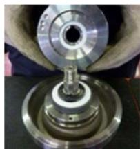
**Fig. 71** Reposer le coupleur magnétique interne (855) sur l'arbre de la turbine (211).
