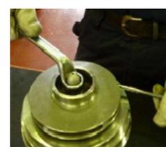
**Fig. 96** Garder la turbine bloquée (230) en introduisant une clé fixe dans le compartiment des pales et visser l'écrou de turbine (922).
