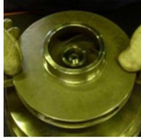
**Fig. 52** Déposer la turbine (230).
