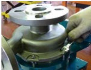
**Fig. 28** Pour un démontage pratique, placer la pompe à la verticale. Démontez le corps de pompe (102) de la lanterne (344) en dévissant les écrous prévus à cet effet (920.1).
