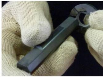
**Fig. 42** Accoupler l'arbre statique (211) et la butée rotative (510). Cette dernière doit avoir les 3 rainures tournées vers la partie la plus interne de l'arbre.
