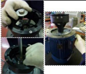
**Fig. 53** Serrer la vis (918) avec sa rondelle (555). Garantir le serrage avec du frein filet de type Loctite 243. Visser le grain (904) sur le coupleur magnétique externe (856).
