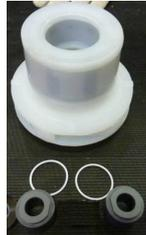
**Fig. 30** Enlever les paliers rotatifs (529) avec leur joint torique de blocage (412.2) de l'ensemble turbine (240).
