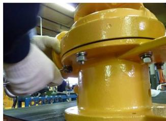
**Fig. 51** Visser les écrous sur les goujons (902.1-902.2) en mettant en place les rondelles et les rondelles de sécurité (931).
