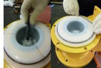
**Fig. 31** Déposer l'arbre statique (211) et la butée rotative (510) du bol d'isolation (157). Déposer le joint torique (412.1) du bol (157).
