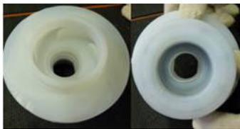
**Fig. 44** Poser le joint torique de blocage des paliers (412.2) dans l'ensemble turbine (240).
