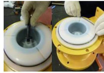
**Fig. 43** Introduire le tout (l'arbre et la butée) dans le bol (157) de façon que les 3 rainures sur la butée soient visibles.
