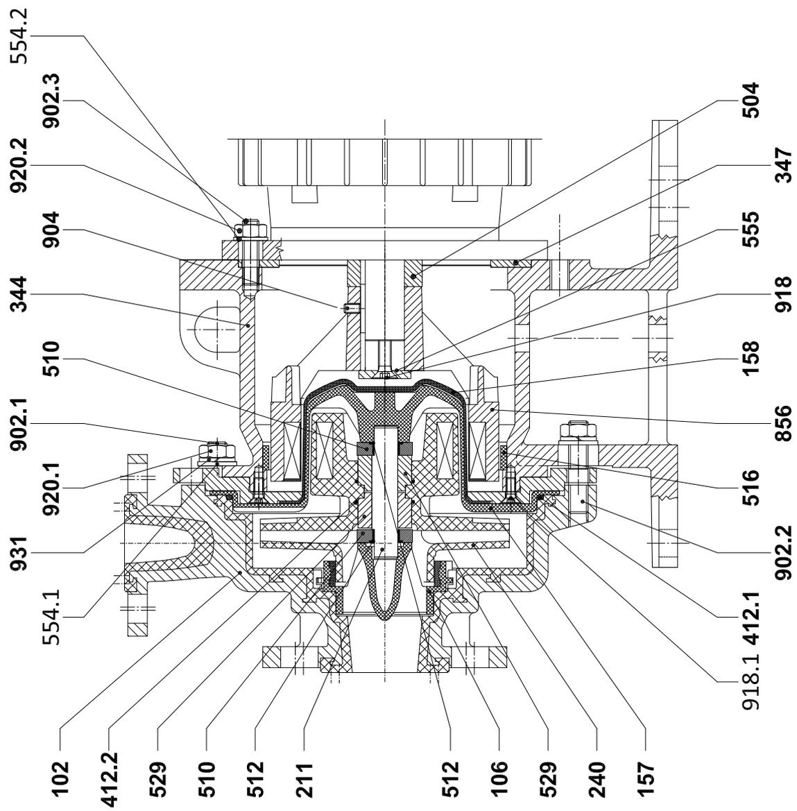
**Fig. 24** Section générale ETN Moteur grandeur 80/90.
