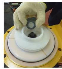
**Fig. 28** Ôter la butée rotative (510) de l'arbre (211).
