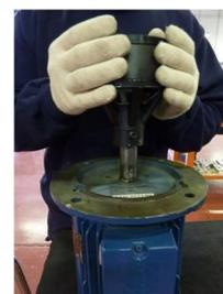
**Fig. 36** Déposer le coupleur magnétique externe (856) du moteur.
