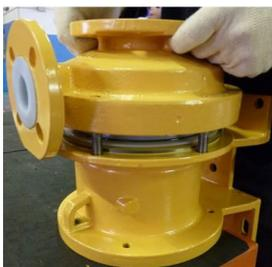
**Fig. 50** Monter le corps de pompe (102) sur la lanterne (344).
