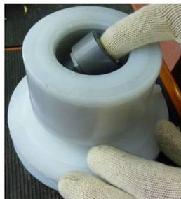
**Fig. 45** Reposer les paliers rotatifs (529) sur l'ensemble turbine (240).
