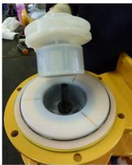
**Fig. 29** Déposer le groupe aimants/turbine (240), avec ses paliers rotatifs (529), de l'arbre (211).
