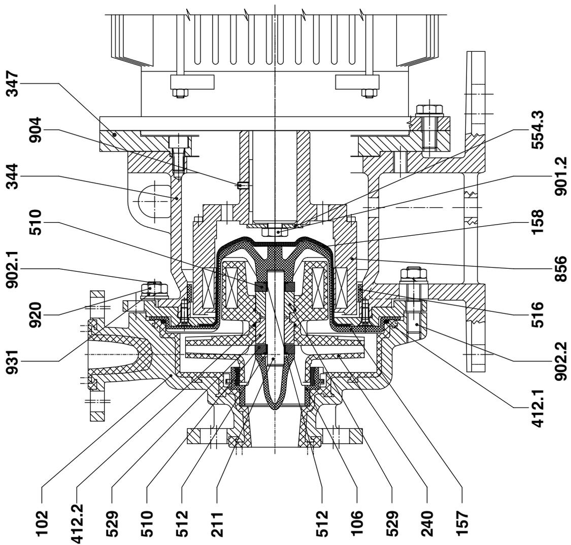
**Fig. 25** Section générique ETN Moteur grandeur 132.
