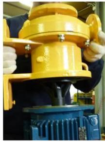
**Fig. 54** Monter le groupe corps de pompe (102) et lanterne (344) déjà assemblés sur l'ensemble moteur-coupleur magnétique externe (856).
