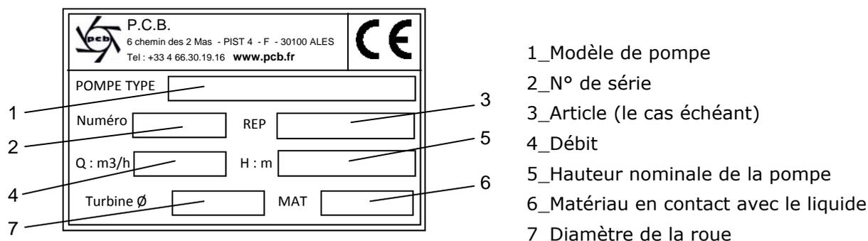
**Fig. 1** PLAQUETTE SIGNALÉTIQUE DE LA POMPE
