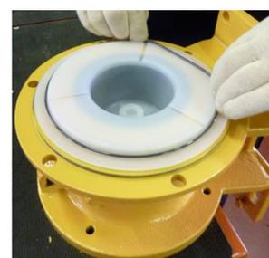
**Fig. 40** Emboîter le joint torique (412.1) sur le bol (157).
