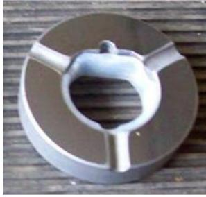
**Fig. 41** Vérifier si la bague de blocage de la butée en PFA (512) est bien introduite dans la butée rotative (510).
