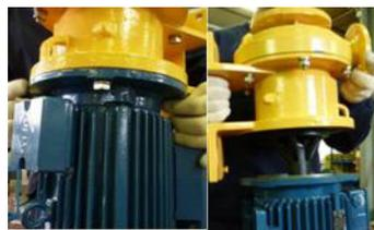
**Fig. 33** Déposer le groupe moteur-coupleur magnétique externe (856) de la lanterne (344) en dévissant les vis.
