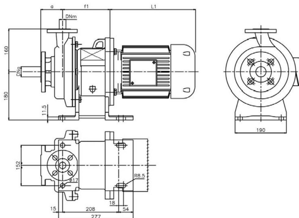
Fig. 56 Schéma d'encombrement (cotes en mm).
