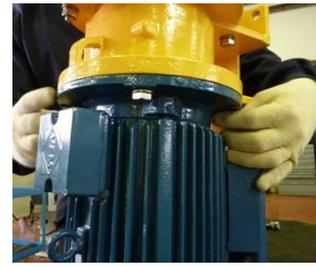
**Fig. 55** Visser le moteur sur la lanterne (344) avec les vis prévues à cet effet en installant les rondelles.
