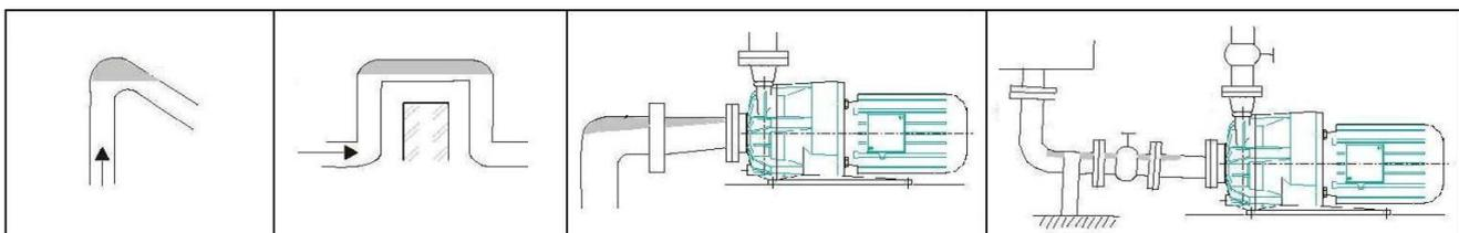
**Fig. 16** Installation déconseillée de la tuyauterie d'aspiration.
