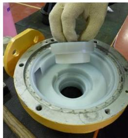
**Fig. 48** Reposer le corps aspirant (106) dans son siège dans le corps de pompe (102) en soumettant le corps aspirant (106) à une rotation dans le sens des aiguilles d'une montre.
