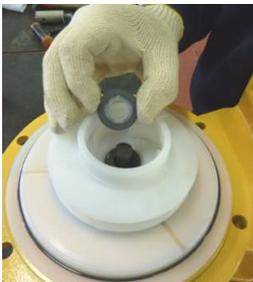
**Fig. 47** Reposer la butée rotative (510) sur l'arbre (211).
