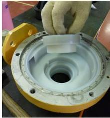
**Fig. 27** Extraire le corps aspirant (106) du corps de pompe (102) en soumettant le corps aspirant à une rotation dans le sens contraire des aiguilles d'une montre.
