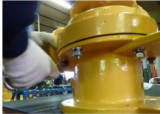
**Fig. 26** Démontez le corps de pompe (102) de la lanterne (344) en dévissant les écrous prévus à cet effet.
