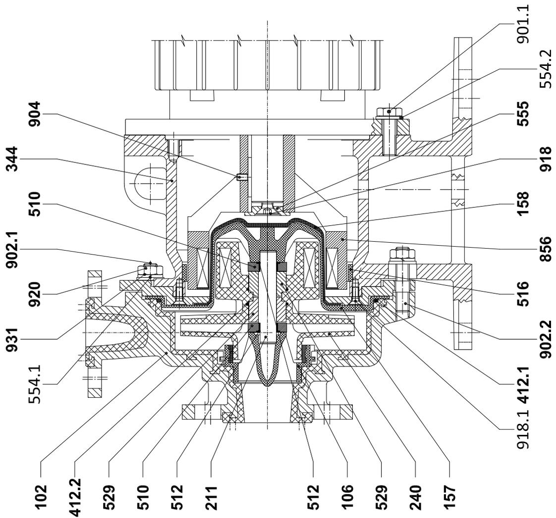
Fig. 23 Section générale ETN Moteur grandeur 100/112.
