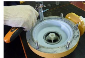
**Fig. 49** Visser les goujons (902.1-902.2) sur le corps de pompe (102) en veillant à faire coïncider les deux goujons les plus longs (902.2) avec les trous diamétralement opposés au tube de refoulement.
