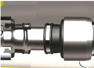
Le manchon de protection de l'articulation offre une surface de contact minimale avec le produit et se trouve dans une position peu exposée à d'éventuels corps solides et / ou tranchants. La technique particulière d'assemblage avec la bague de protection de l'articulation en acier inoxydable, assure non seulement la parfaite étanchéité de l'articulation à haute pression, mais élimine l'utilisation d'une seconde partie, généralement très sollicitée dans les solutions habituellement adoptées.
